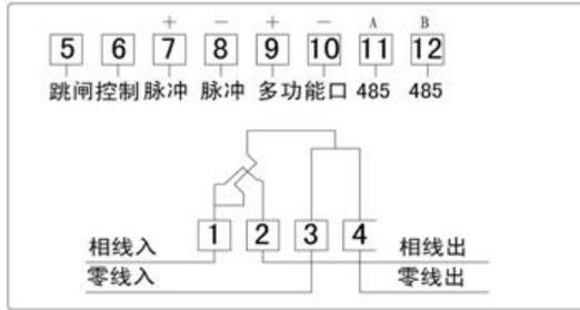
说明：采用内置负荷开关时 5、6 端子为预留端子；采用外置负荷开关时 5、6 端子为跳闸控制端子。
